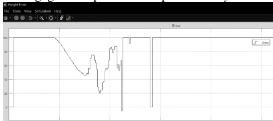
Gambar 20. Hasil Error Ketinggian Terbang Drone Tanpa Fuzzy
