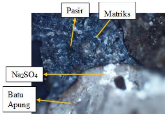
Gambar 9. Foto Mikro Spesimen Dengan Perendaman 15% Natrium Sulfat Dengan Pembesaran 5x
