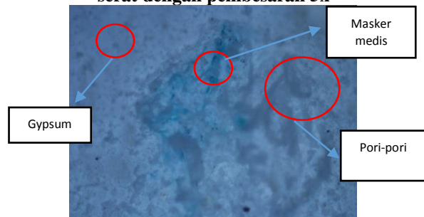
Gambar 7. foto mikro komposit fraksi volume 5% serat dengan pembesaran 5x
