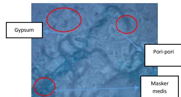
Gambar 8. foto mikro komposit fraksi volume 10% serat dengan pembesaran 5x
