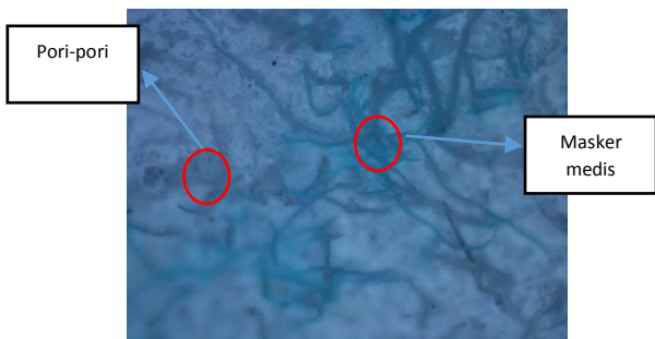
Gambar 9. foto mikro komposit fraksi volume 15% serat dengan pembesaran 5x
