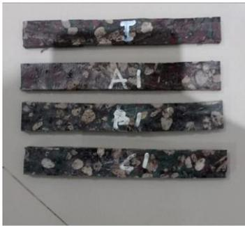
Gambar 7. Spesimen setelah uji bending
