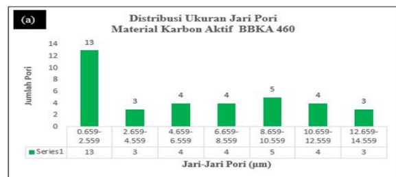
Gambar 4. Struktur pori material karbon aktif bambu betung
