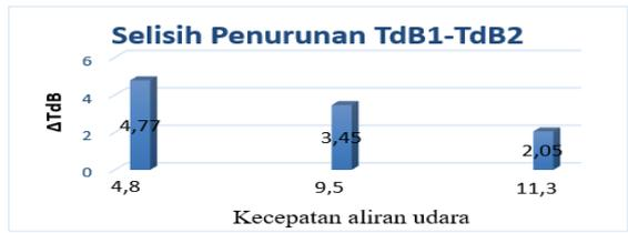
**Gambar 4. Grafik Selisih Penurunan Temperatur  $\Delta T_{dB1}-\Delta T_{dB2}$**
