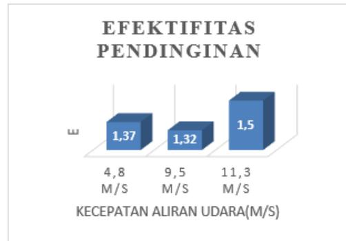
**Gambar 6. Grafik Efektifitas pendinginan ( $\epsilon$ ) Terhadap Kecepatan Aliran Udara (m/s)**
