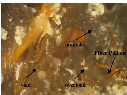
Gambar 4. Foto mikro spesimen 2,5% serat
