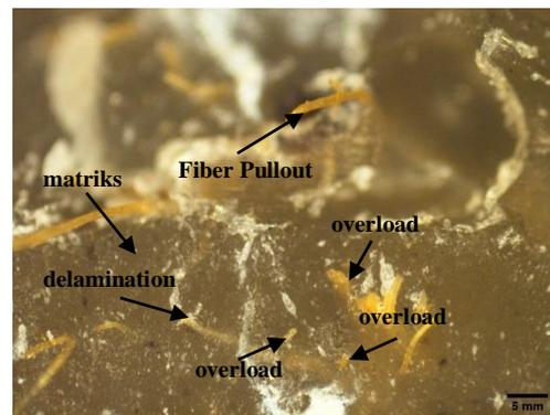
Gambar 5. Foto mikro spesimen 5% serat
