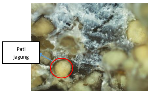
Gambar 10. foto micro komposit variasi S3 dengan pembesaran 5x
