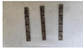
Gambar 3. Spesimen uji bending
