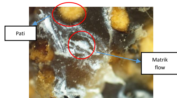
Gambar 9. foto micro komposit variasi S2 dengan pembesaran 5x
