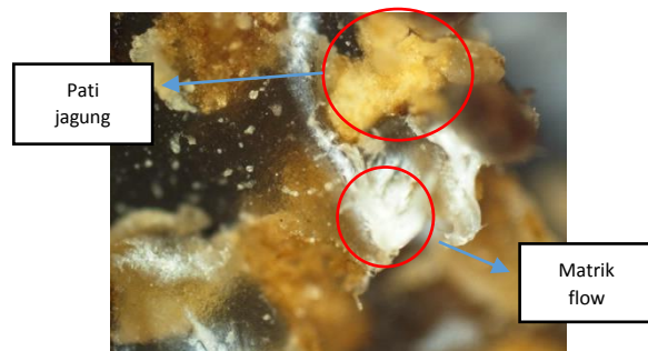
Gambar 8. foto micro komposit variasi S1 dengan pembesaran 5x
