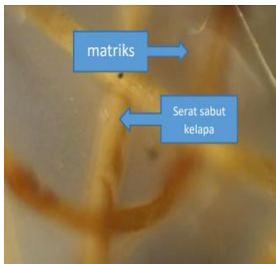
Gambar 4. Foto mikro spesimen 10% serat
