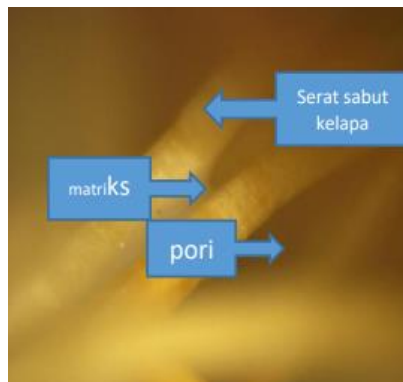
Gambar 5. Foto mikro spesimen 20% serat
