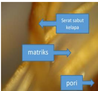
Gambar 6. Foto mikro spesimen 30% serat
