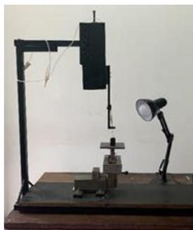
**Gambar 5.**Pengujian Sudut Kontak
