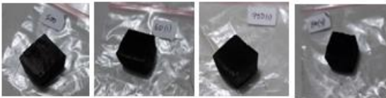
Gambar 4 . Karbon Aktif Bambu Betung Hasil Proses Aktivasi
