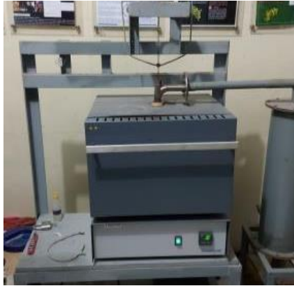
Gambar 2. Peralatan proses karbonisasi
