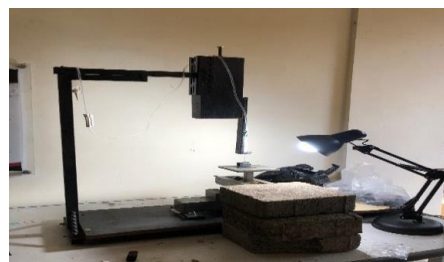
Gambar 2. Alat Uji Sifat Mampu Basah
