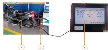
Gambar 3. Uji Emisi Gas Buang
