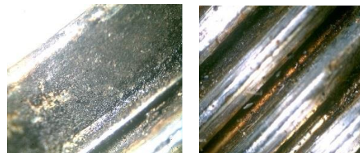
Gambar 6 Kerak pada ujung elektroda dan ulir busi iridium
