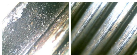
Gambar 4 Kerak pada ujung elektroda dan ulir pada busi standar
