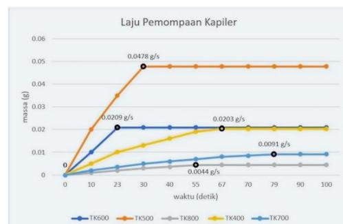
Gambar 6. Laju pemompaan kapiler material karbon bambu betung
