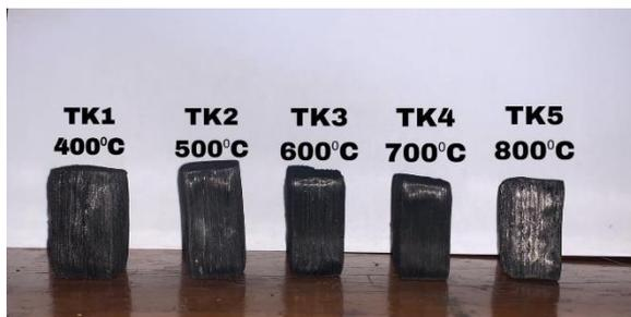
Gambar 5. Spesimen material karbon bambu betung
