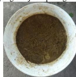
Gambar 5. Campuran limbah (Slurry) dengan perbandingan 1:1
