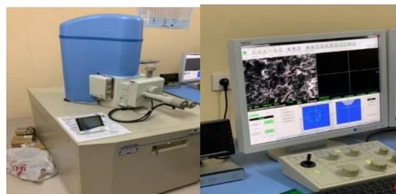
Gambar 2. Peralatan uji SEM
