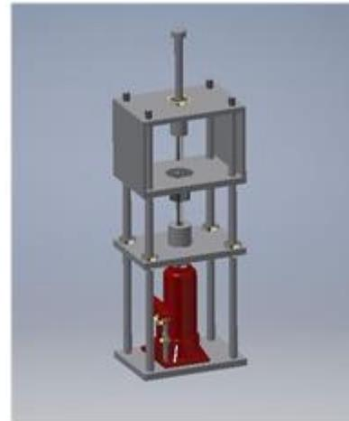
**Gambar 1. Rancangan alat pembuat pellet karbon aktif**
