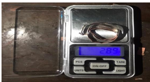
Gambar 2. Hasil Berat Spesimen I Setelah Di Elektroplating Tanpa Kerak
