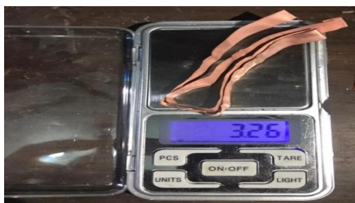
Gambar 3. Hasil Berat Spesimen II Setelah Di Elektroplating Tanpa Kerak.
