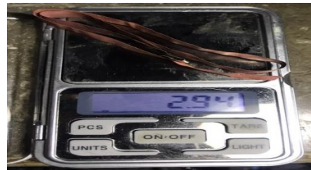
Gambar 4. Hasil Berat Spesimen I Setelah Di Elektroplating Tanpa Kerak.
