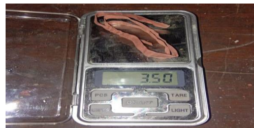
Gambar 6. Hasil Berat Spesimen II Setelah Di Elektroplating Tanpa Kerak.
