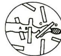
Gambar 4. Mekanisme Kegagalan Pada Patahan
