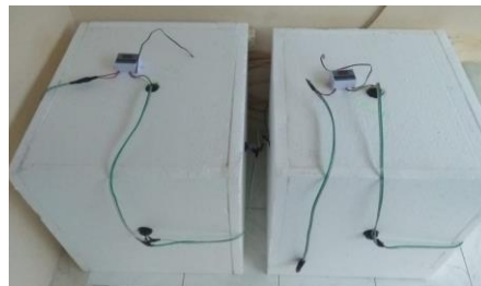
Gambar 4. Pemanas dengan temperatur konstan sebesar 54°C
