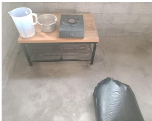
Gambar 8. Pengujian laju pembakaran biogas kotoran gajah
