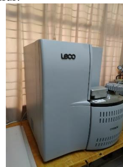
Gambar 5. Alat Uji Ultimate
