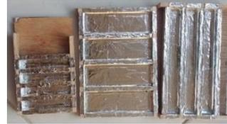
**Gambar 4. Cetakan spesimen**
