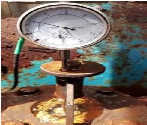
Gambar 6. Hasil visualisasi gerakan katup limbah tahap akselerasi
