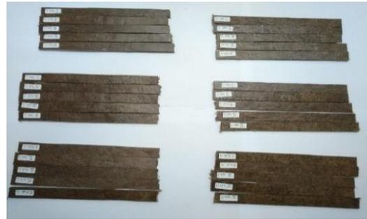
**Gambar 10. Hasil pemotongan spesimen uji tarik**
