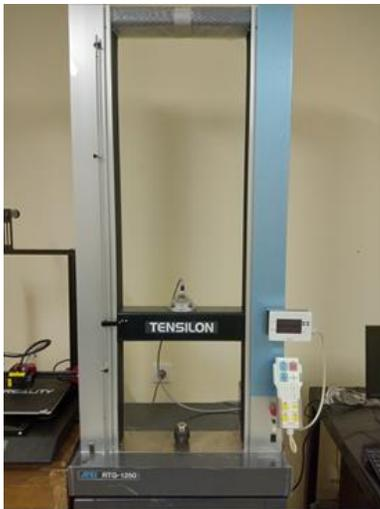
Gambar 3. Alat Uji Tensilon RTG 1250
