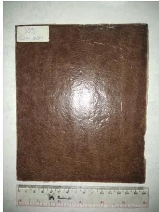
**Gambar 5. Komposit Hybrid Setelah Proses Cetakan**
