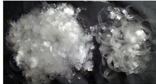
**Gambar 1. Plastik air mineral bekas berukuran 220 ml**
