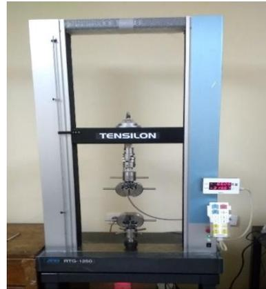
Gambar 6. Alat uji mekanik tensilon RTG-1250 Universitas Udayana
