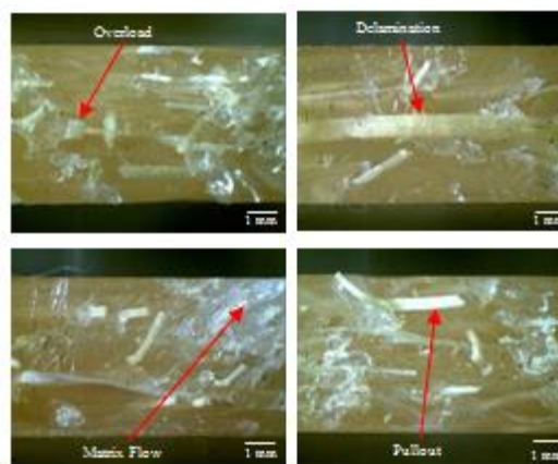
Gambar 12. Hasil Foto Makro Patahan Komposit
