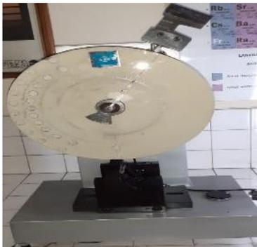
Gambar 5. Proses uji impact
