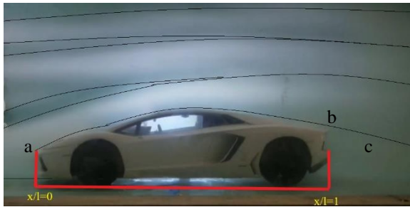
Gambar 4. Pola Aliran Udara Pada Model Sport.
