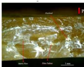
Gambar 11. Foto Makro Patahan Komposit Fraksi Berat 5% Perlakuan 4 jam
