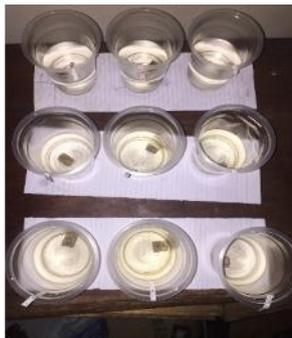
Gambar 8. Pengujian Daya Serap Air
