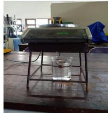
**Gambar 6. Pengujian Densitas**
