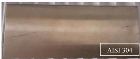
Gambar 6. Logam Induk Stainless Steel AISI 304
