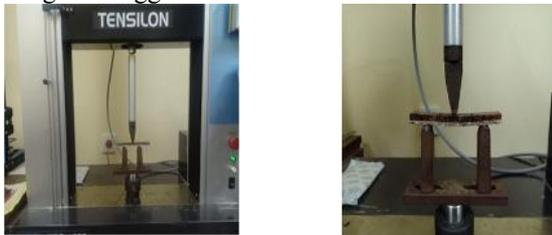
**Gambar 6. Pengujian Bending**
