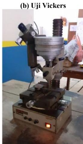
Gambar 11 Alat Uji Vickers
