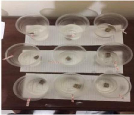
Gambar 8. Pengujian Daya Serap Air
