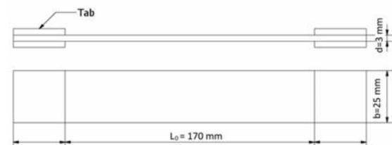
Gambar 1. Spesimen Uji Tarik
