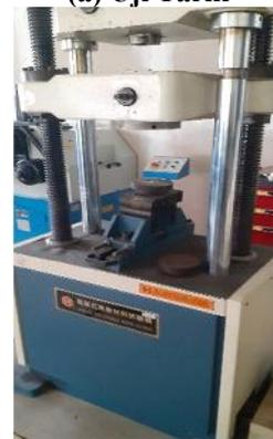
Gambar 10. Mesin Uji Tarik
