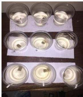
Gambar 8. Pengujian Daya Serap Air
