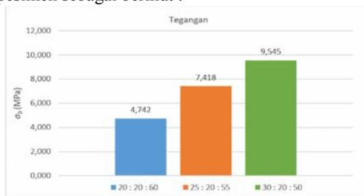
**Gambar 7. Grafik Tegangan Bending**
