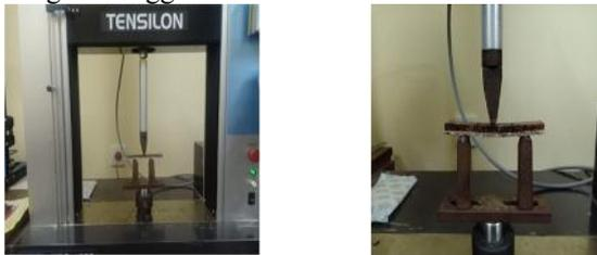
**Gambar 6. Pengujian Bending**
