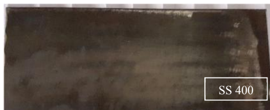
Gambar 7. Logam induk baja karbon rendah SS 400
