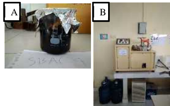
Gambar 4. (A) Aktivasi kimia KOH 3 M variasi waktu aktivasi kimia 2 jam, 4 jam, 6 jam ( B ) Impregnasi menggunakan Autoklaf
