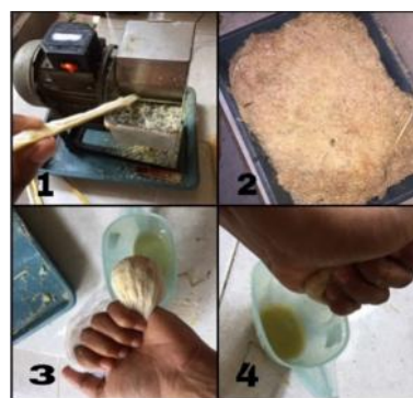
Gambar 1. Proses Pengambilan Nira Batang Tanaman Sorgum
