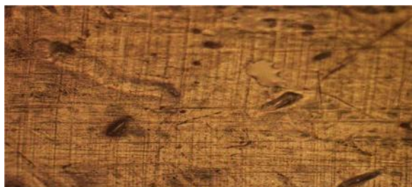
Gambar.9 hasil uji struktur mikro pada spesimen dengan variasi 15% NaOH
