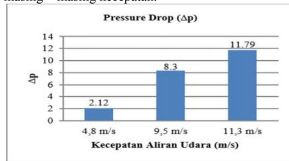
Gambar 12. Grafik Pressure Drop ( $\Delta p$ ) Terhadap Kecepatan Aliran Udara (m/s)
