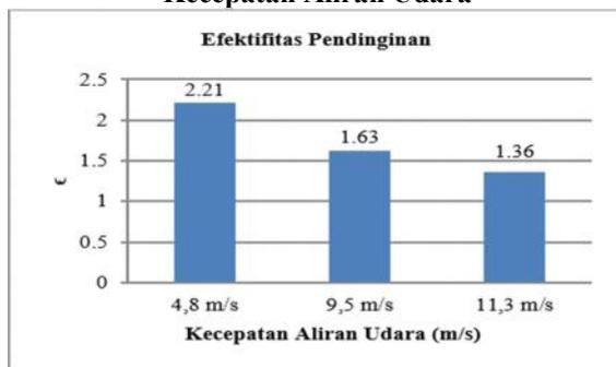
Gambar 9. Grafik Efektifitas Pendinginan ( $\epsilon$ ) Terhadap Kecepatan Udara (m/s)
