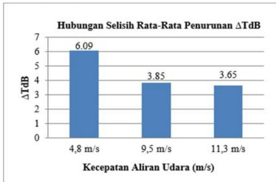
Gambar 8. Grafik Hubungan Antara Selisih Rata-Rata Penurunan Temperatur Terhadap Kecepatan Aliran Udara
