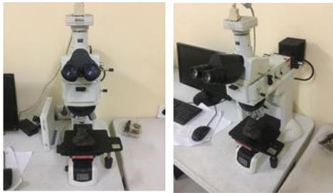
Gambar 4. Alat Uji Struktur Mikro (Sumber: Observasi, 13 Maret 2018)
