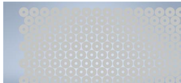
Gambar 5. Pipa disusun secara Staggered
