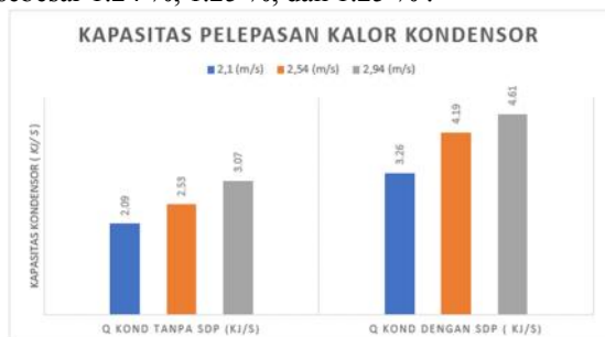
Gambar 6. Grafik perbandingan kapasitas laju aliran kalor pada kondensor tanpa menggunakan in-line solid dry pad dan dengan menggunakan in-line solid dry pad
