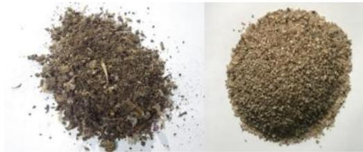
Gambar 3. Sampah kota yang telah dicacah dan pasir silika dengan ukuran antara 0.4 – 0.5 mm
