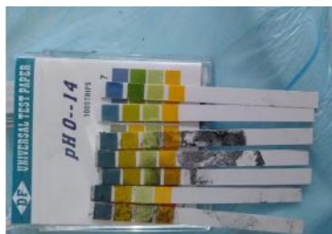
Gambar 3. Perubahan warna kertas lakmus setelah beberapa kali proses pencucian
