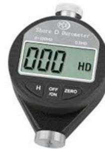
**Gambar 1. Alat Uji Kekerasan Shore D**
