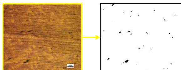
Gambar 13. Analisa mikrostruktur permukaan pada spesimen dengan temperatur pemanasan 300°C, (A) Daerah Logam Induk, (B) HAZ, (C) Las.
