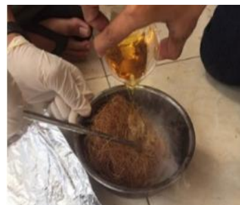
Gambar 3. Pencampuran Serat Sabut Kelapa dan Getah Pinus
