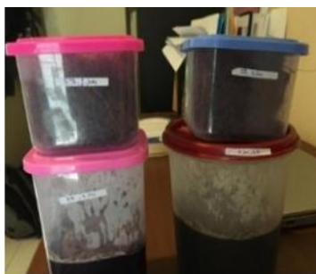
Gambar 1. Perlakuan Alkali (NaOH) pada Serat
