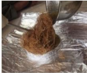
(a) Penuangan Green Composite ke Cetakan
