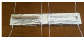
Gambar 1 Cetakan spesimen sesuai standar ASTM D-638-02a
