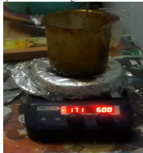
Gambar 2 Proses pemanasan getah Pinus
