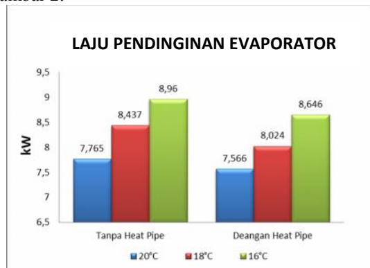
Gambar 2. Grafik Laju Pendinginan Evaporator AC
