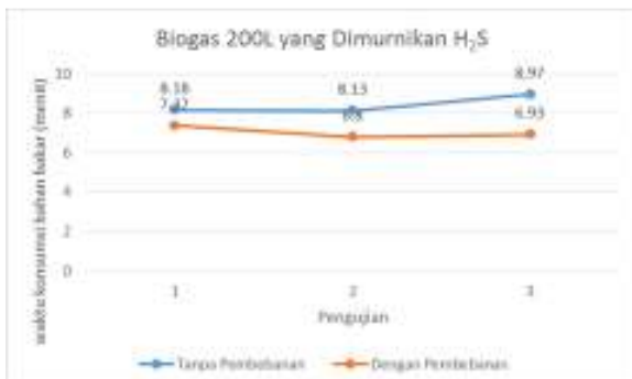
Gambar 3. Grafik waktu konsumsi bahan bakar biogas 200L yang dimurnikan H 2 S
