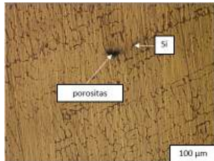
Gambar 13 struktur mikro dengan mesh pasir 0,315 mm dan densitas lost foam 0,038 g/cm 3
