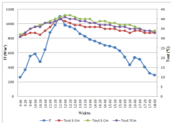
Gambar 10. Grafik perbandingan, T_{out} kerenggangan 3 cm, 5 cm, 7 cm pipa absorber berbentuk spiral.
