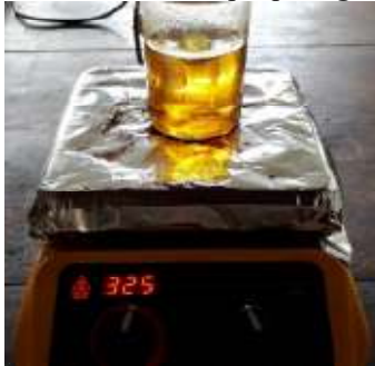
Gambar 5. Getah pinus pada saat heat treatment
