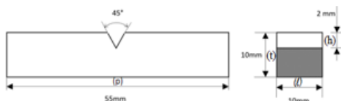
Gambar 2 Spesimen uji dampak (ASTM E 23)
