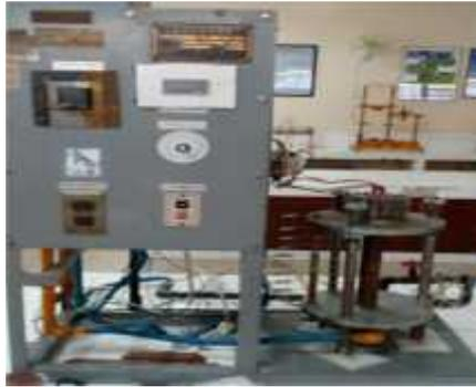
Gambar 2. Alat uji konduktivitas termal
