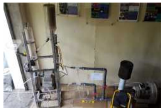
Gambar 3. Foto alat uji DRFB berbahan pipa akrilik
