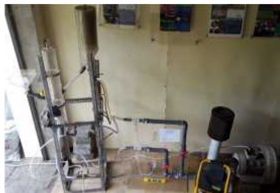
Gambar 2. Foto alat uji DRFB berbahan pipa akrilik
